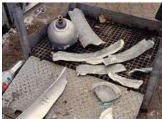
Figura 3. Esplosione di bombola di idrogeno
