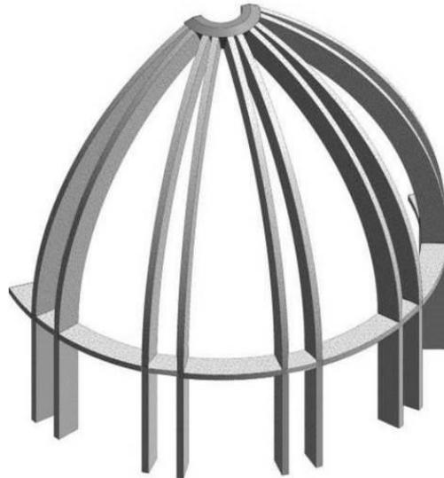
Fig. 10: struttura portante cupola/dome structural elements.
